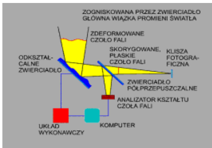
Rys. 6. Schemat ideowy układu optyki adaptacyjnej.
